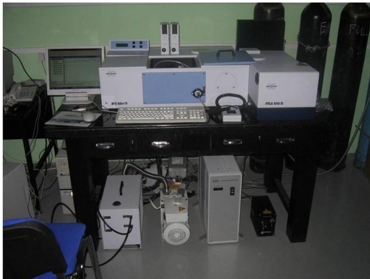
*Рисунок 9. ИК-спектрометр*
