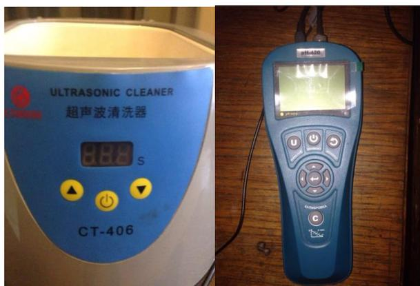
Рисунок 21. Ультразвуковая ванна слева, рН-метр справа
