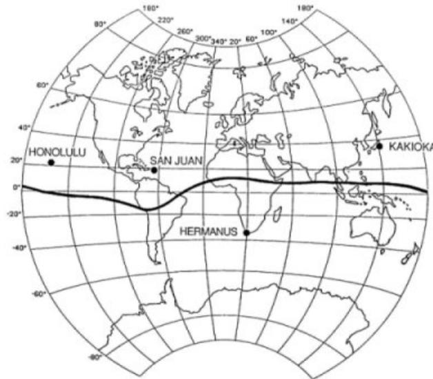
Рисунок 1.3 Схематичное расположение станций, на основе данных которых вычисляется Dst-индекс (<http://www.ingv.it/ufficio-stampa/research-areas/sun-earth/dst-geomagnetic-index>).
