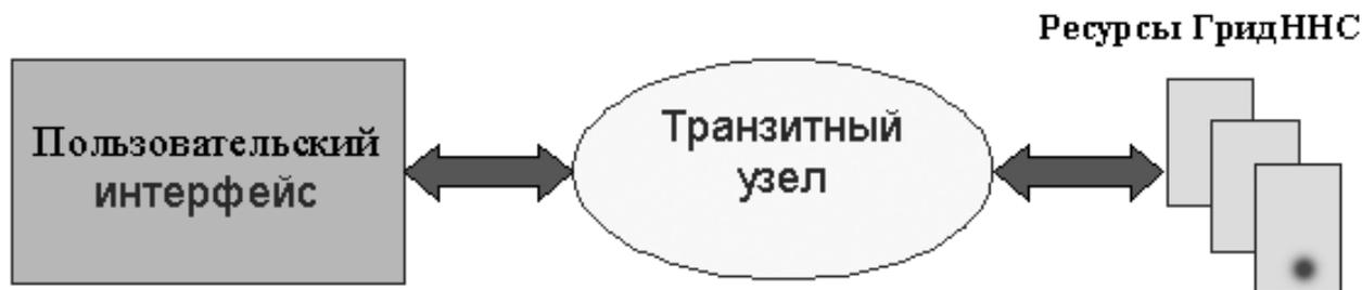
Рис. 1: Упрощенная схема узла связи СКИФ-ГРИД с ГридННС.
