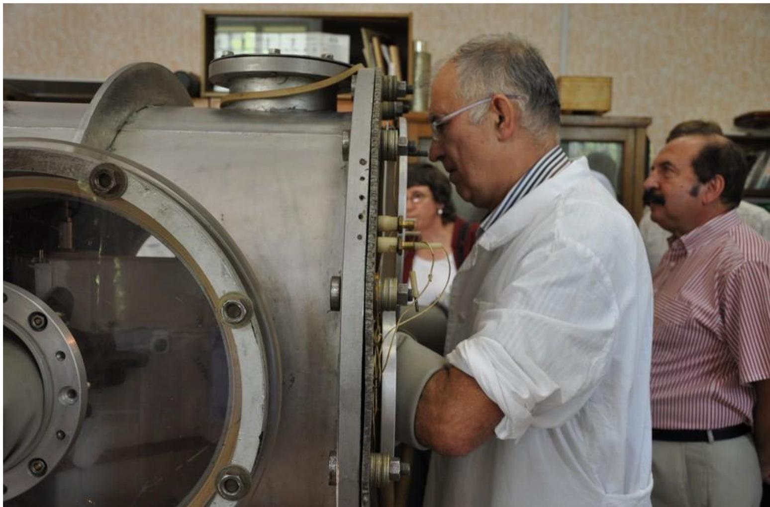
Показана процедура вскрытия гермоконтейнера внутри камеры, заполненной аргоном, извлечения и раскрытия кассет для извлечения образцов. Затем там же внутри камеры образцы помещались в гермопеналы для передачи заинтересованным организациям для исследования.
