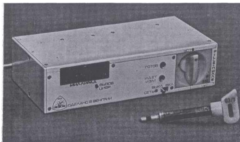
Рис. 3. Бортовой дозиметрический пульт «Пилле» с датчиком
