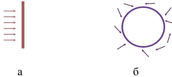
Рисунок 1.3. Две конфигурации защитного экрана и излучения: а – полубесконечный плоский экран при воздействии параллельного потока излучения; б – сферическая оболочка при воздействии изотропного потока излучения
