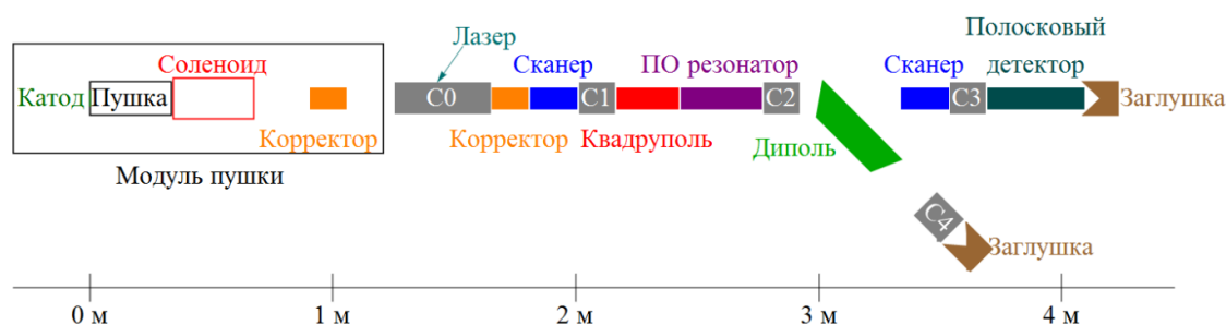
Рис. 2.1. Схема линии диагностики пучка в проекте GunLab
