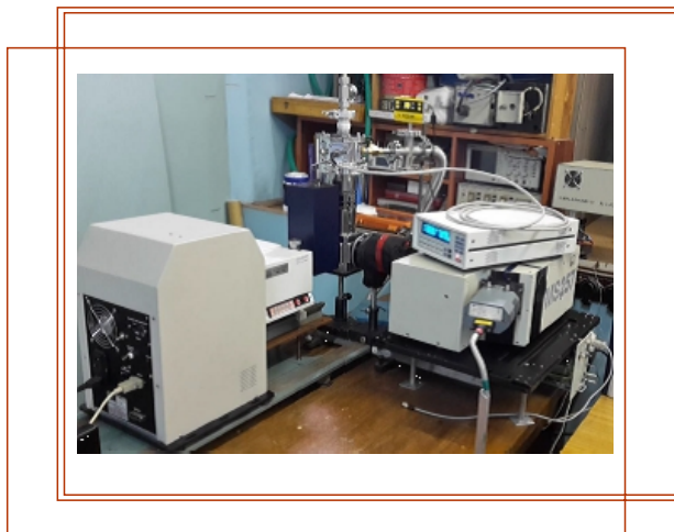
Установка для люминесцентной спектроскопии отдела физических проблем квантовой электроники НИИЯФ МГУ. Энергетический диапазон 2 – 6 эВ
