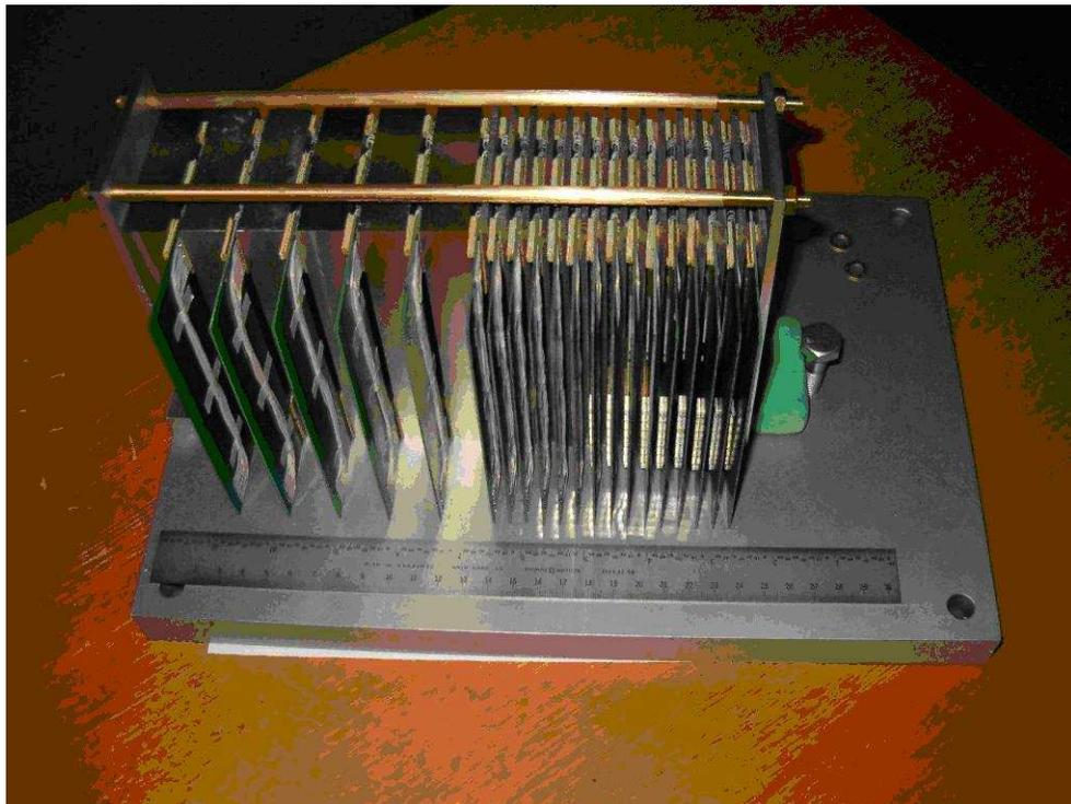
Рис. 7. Структура прототипа электромагнитного калориметра PHENIX.
