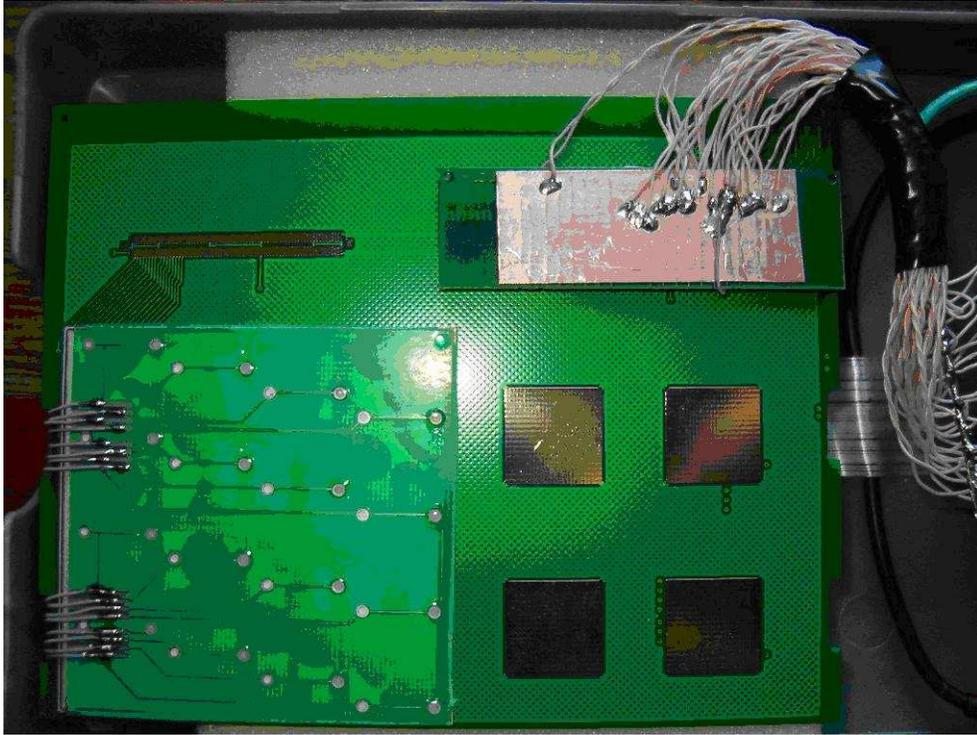
Рис. 8. Общий вид детекторной платы (в правом верхнем углу показан разъем для тестирования).
