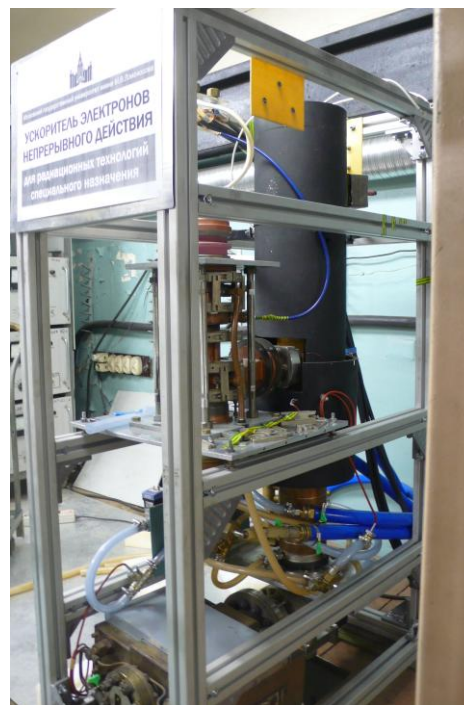
2013 г. Линейный ускоритель непрерывного действия 1 МэВ/25 кВт
