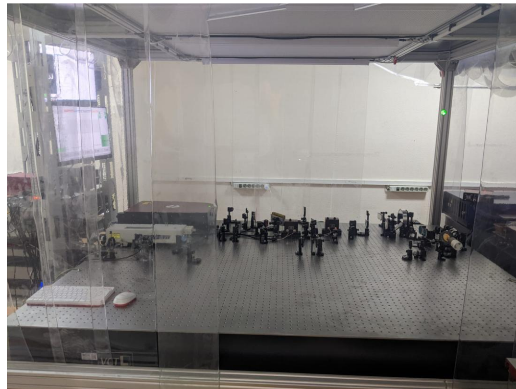
Подготовка лазерных систем фотокатода и точки взаимодействия
