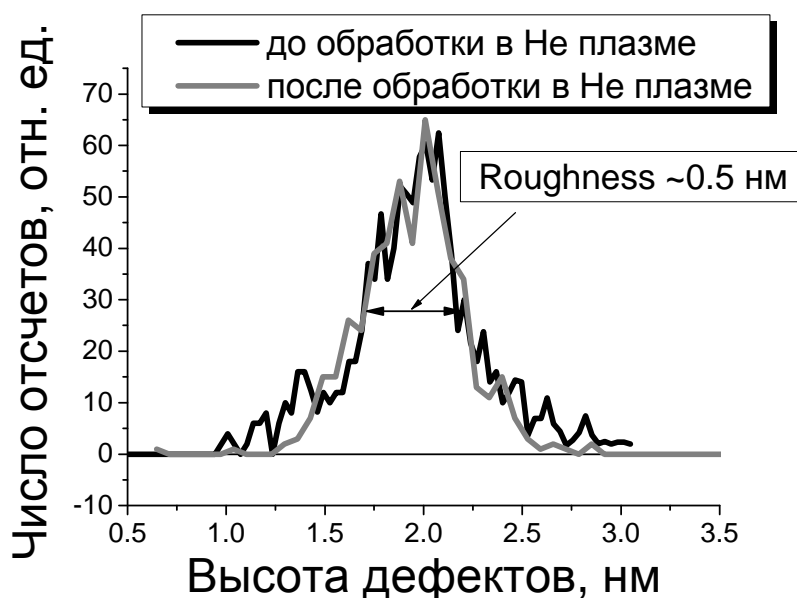
Рис. 4. Грубость поверхности до и после обработки в He плазме (подробнее об обработке см Главу 4).
